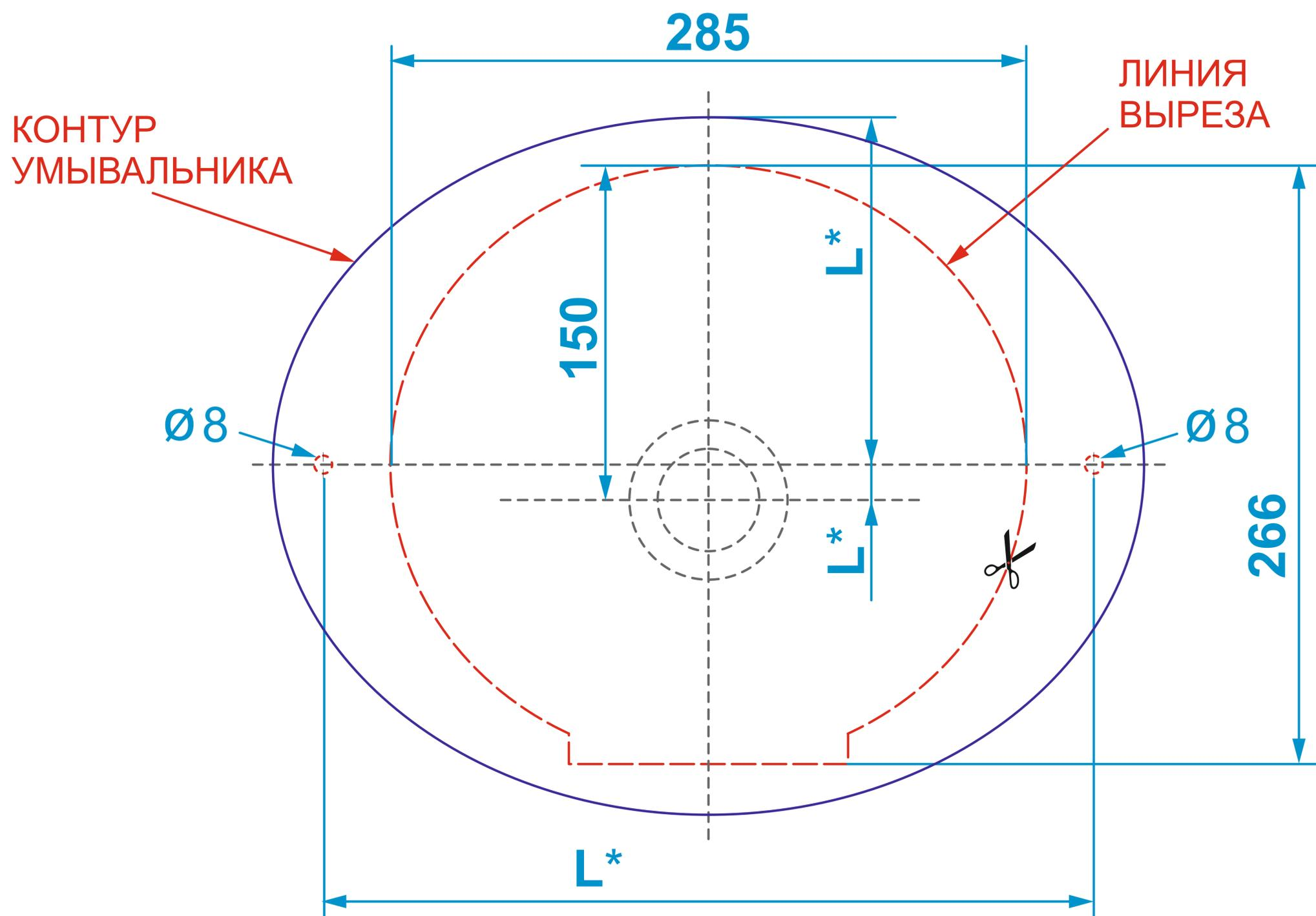
\* - РАЗМЕР ИЗМЕРЯТЬ ИСХОДЯ ИЗ ИМЕЮЩЕГОСЯ УМЫВАЛЬНИКА
